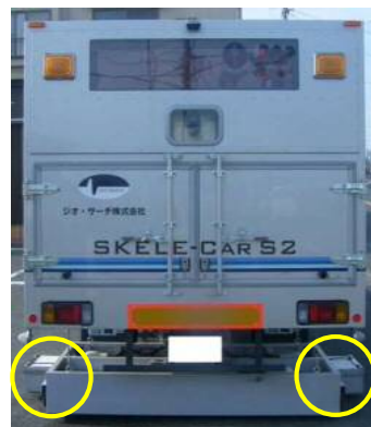
(写真-5) レーダ張り出し時
