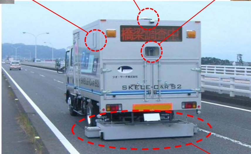
(写真-4) 地中レーダ装置
