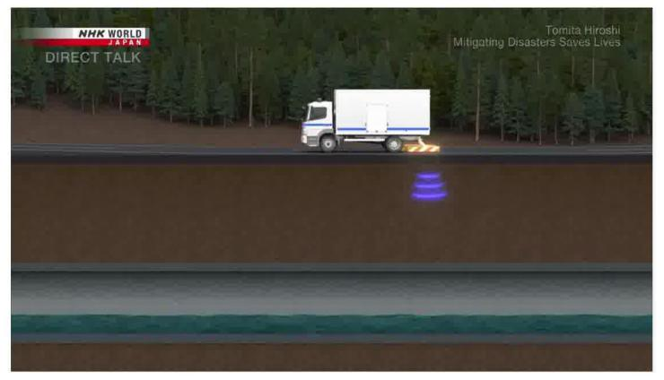
As it moves down the road, the surveying vehicle uses ground penetrating radar. By analyzing the data obtained from these scans, they can identify cavities likely to cause a road collapse. 路面下探査車は地中レーダを使用して、道路を走行しながら探査を行います。そこで得られたデータを分析することで、道路陥没を引き起こす可能 性のある路面下空洞を発見できます。
